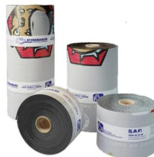
Manta asfáltica auto-adesiva pré-fabricada produzida em diversas larguras para facilitar a impermeabilização de vigas de baldrame, reforços ou acabamentos. Fabricadas a base de asfaltos modificados com polímeros elastoméricos que proporcionam ao asfalto alta flexibilidade, aderência e durabilidade. Possui reforço central de filme sintético de alta resistência e alongação. A face inferior é composta por filme de polietileno PEAD siliconado para facilitar sua remoção.
