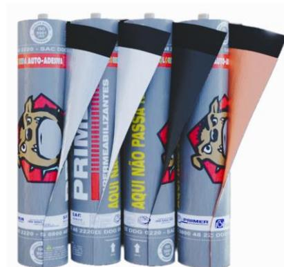
Manta asfáltica auto-adesiva pré-fabricada a base de asfaltos modificados com polímeros elastoméricos que proporcionam ao asfalto excelente aderência, flexibilidade e durabilidade. Possui reforço central de filme sintético de alta resistência e alongação. Autoprotetida na superfície exposta com filme de alumínio flexível ALU-FLEX COLORIDO para proteção dos raios solares UV, a face inferior é composta por filme de polietileno PEAD siliconado de fácil remoção.
