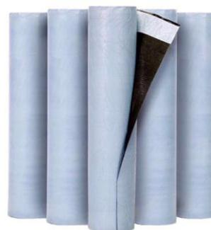
Manta asfáltica auto-adesiva pré-fabricada a base de asfaltos modificados com polímeros elastoméricos que proporcionam ao asfalto excelente aderência, flexibilidade e durabilidade. Possui reforço central de não tecido de poliéster de alta resistência à tração, alongação e ao puncionamento.
