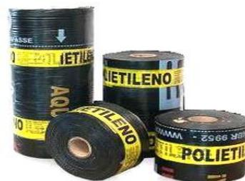
Manta asfáltica pré-fabricada produzida em diversas larguras para facilitar a impermeabilização de vigas de baldrame, reforços ou acabamentos. Fabricadas a base de asfaltos modificados com polímeros que proporcionam ao asfalto alta flexibilidade, aderência e durabilidade. Possui reforço central de filme sintético de alta resistência e alongação. A face inferior é composta por filme de polietileno PEAD ultrafino para facilitar a colagem a maçarico.
