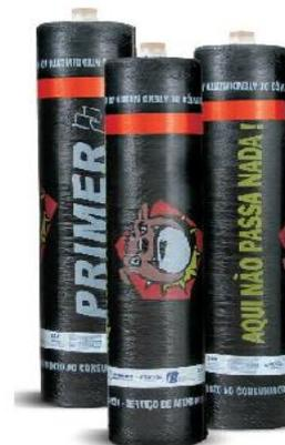
Manta asfáltica pré-fabricada a base de asfaltos modificados com polímeros que proporcionam ao asfalto alta flexibilidade, aderência e durabilidade. Possui reforço central de filme sintético de alta resistência e alongação. Autoprottegida na superfície exposta com filme de alumínio flexível ALU-FLEX COLORIDO para proteção dos raios solares UV, a face inferior é composta por filme de polietileno PEAD ultrafino para facilitar a colagem a maçarico.
