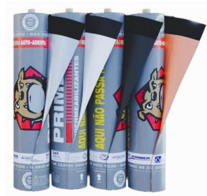
Manta asfáltica auto-adesiva pré-fabricada a base de asfaltos modificados com polímeros elastoméricos que proporcionam ao asfalto excelente aderência, flexibilidade e durabilidade. Possui reforço central de não tecido de poliéster de alta resistência à tração ao puncionamento e alongação. Autoprotetida na superfície exposta com filme de alumínio flexível ALU-FLEX COLORIDO para proteção dos raios solares UV, a face inferior é composta por filme de polietileno PEAD siliconado de fácil remoção.
