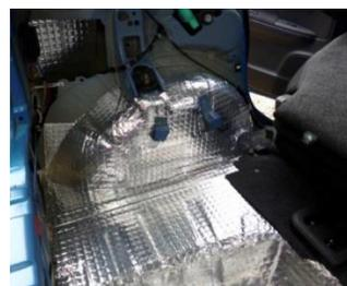
Manta asfáltica veicular auto-adesiva, pré-fabricada à base de asfaltos modificados com polímeros elastoméricos de alto poder de aderência e durabilidade, possui reforço central de filme sintético de alta resistência e alongação. Auto protegida na superfície exposta com filme de alumínio flexível ALU-FLEX , a face inferior é composta de filme de polietileno siliconado antiaderente de fácil e rápida remoção.
