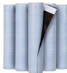
Manta asfáltica auto-adesiva pré-fabricada a base de asfaltos modificados com polímeros elastoméricos que proporcionam ao asfalto excelente aderência, flexibilidade e durabilidade. Possui reforço central de filme sintético de alta resistência e alongação. A face inferior é composta por filme de polietileno PEAD siliconado de fácil remoção.
